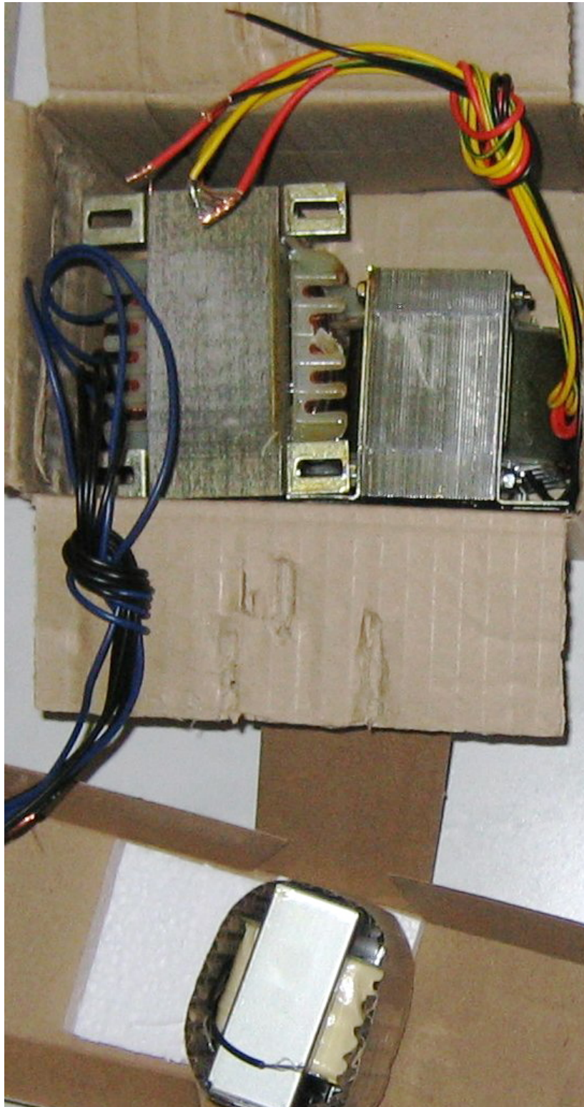
Transformateurs et self ...
