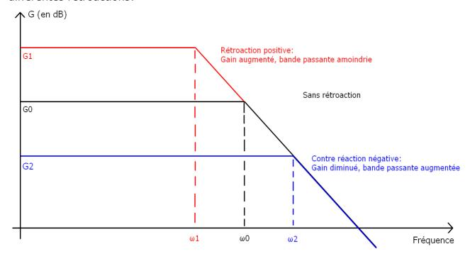
Comme on l'a dit précédemment, ce raisonnement est aussi faisable avec les filtres passe-haut et les filtres passe-bande, il suffit de prendre l'expression du filtre et de lui appliquer la formule de Black, et de la remettre sous la forme d'un filtre.
