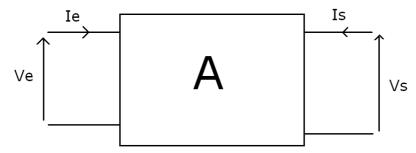
Par exemple, un pont diviseur de tension sera représenté par le quadripôle suivant :
