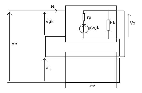
Nous remarquons un générateur  $\mu$  (Ve-Vk) qui alimente le pont diviseur de tension formé par rp et Rk. On a donc Vs=  $\mu$  (Ve-Vk)\*Rk/(rp+Rk). De plus, Vk = Vs, donc on remplace dans la formule:
