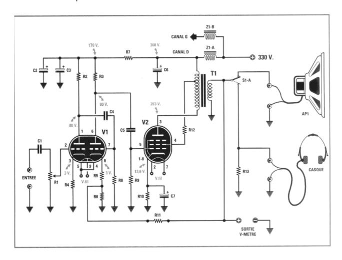
Ici la boucle de rétroaction est réalisée par le pont diviseur formé par R6 et R11. La soustraction de signaux est réalisée de manière spéciale. En effet, le montage à cathode commune formé par la deuxième triode de V1 fait que le signal traversant cette triode est déphasé de 180° avec le signal en sortie de transformateur, et donc les deux signaux sont de signe opposés; on réalise donc la soustraction des deux signaux de cette manière.
