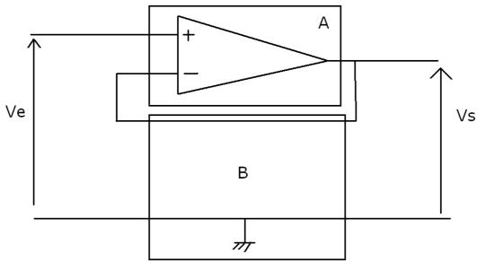
Le bloc A est l'ampli opérationnel seul, de gain interne de l'ordre de 100.000 . Le bloc B est un simple rebouclage par un câble, de gain unité.
