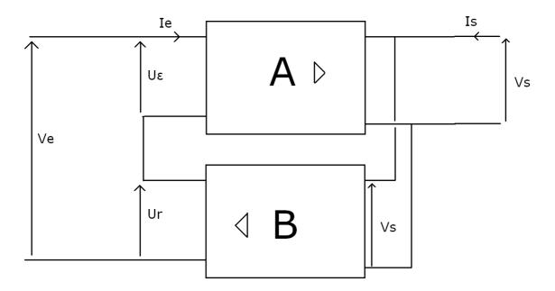
On voit que les branchements réalisés permettent de réaliser  $U\epsilon$  =Ve-Ur . De plus, la tension d'entrée de B est la tension de sortie de A.
